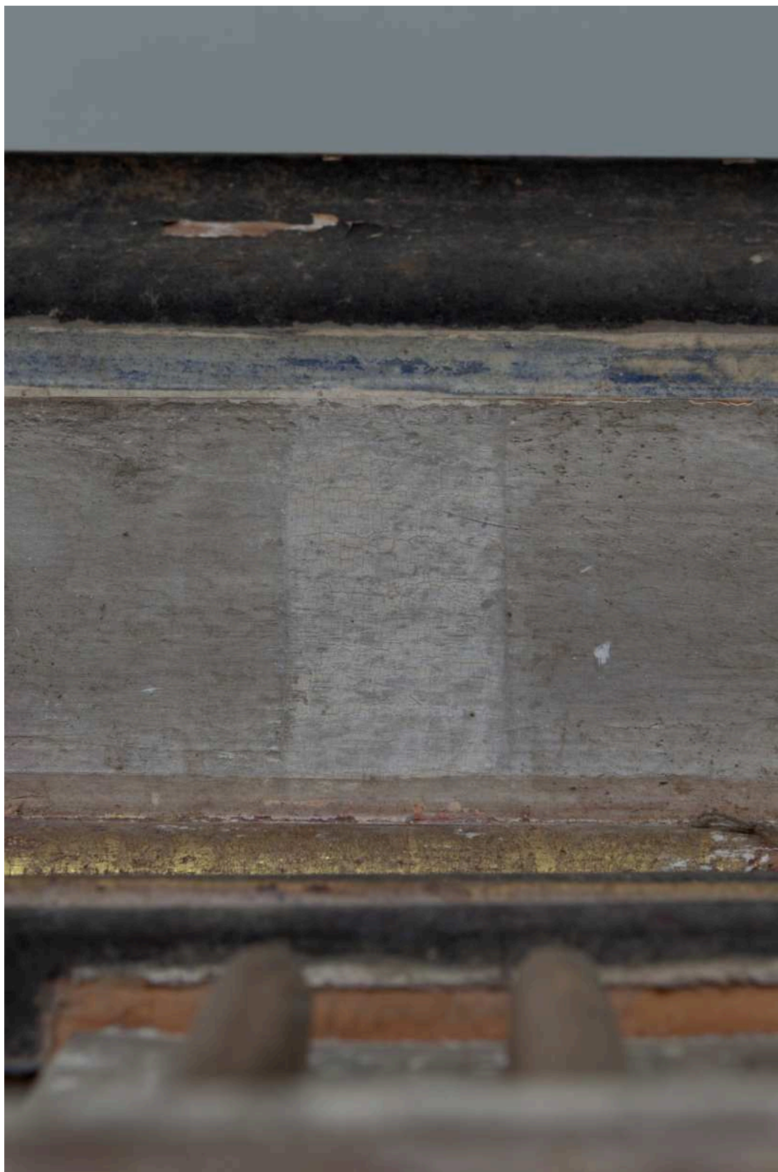
S03 - zkouška snímání prach. depositů - architráv (profilace)
